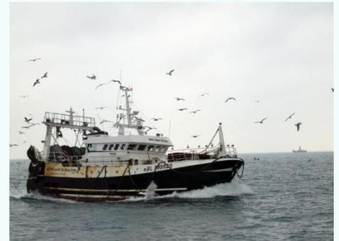
**Figure 8** : Chalutier de fond à panneaux en pêche (Source : CRPMEM Nord-Pas de Calais/Picardie).
